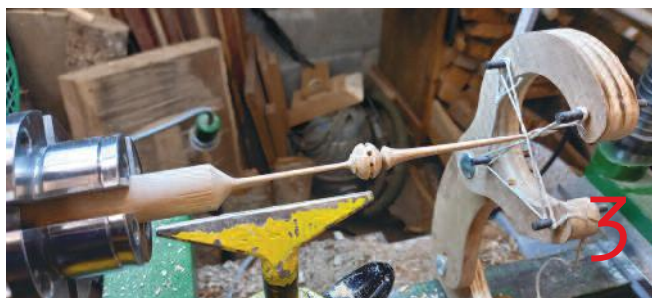
3. Pose de la première lunette pour la mise en place des fils selon la méthode Azema.
