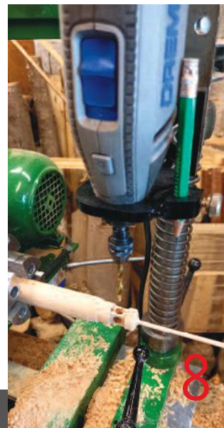
8. Alésage de la figure rectangulaire avec la Dremel, déplacements latéraux (manivelle ou avance automatique).
