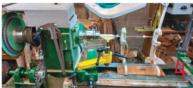
4. Pose de la deuxième lunette, même exercice. Particularité : on va la liaisonner à la première. En effet, il s'agit d'avoir un déplacement latéral homogène des deux lunettes en fonction de l'avance des figures. Pour cela, j'utilise un demi-maillon de chaîne sur les platines intermédiaires et ainsi de suite en fonction des passages jusque à la fin du trembleur long de 1 mètre. On ne défait pas les fils. Le porte-outil est déporté. Avantage : confort et rapidité de travail pour l'annuler ou le remettre.
