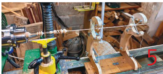
5. Réalisation des figures : torsade par fraisage et diviseur situé sur l'avance latérale, texturage à l'aide d'une molette.
