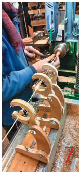
7. Dépouillage des segments fins à la gouge.
