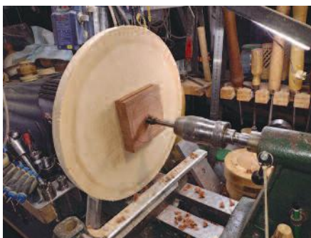
Perçage du trou de « prise de mandrin ».
