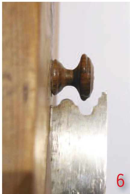
Curettes pour moulures ovoïdes, bouton de tiroir et deux affiloirs pour redresser le fil des outils après affûtage.
