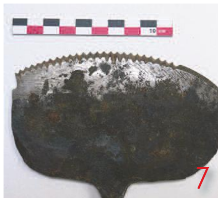
Très large curette crantée pour faire des stries sur des canettes de navettes pour les métiers à tisser lyonnais. Outil utilisé par mon grand-père vers 1930/1950.
