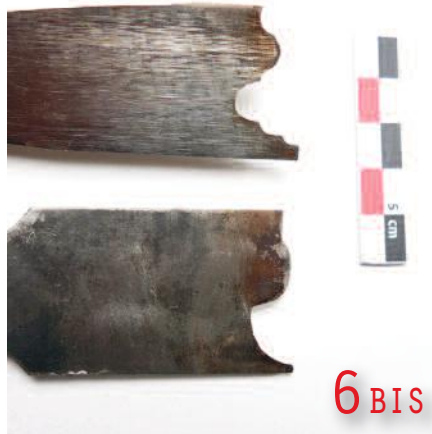
6 et 6 bis. Curettes pour fabriquer des boutons de tiroir, dont le modèle en bois est assez courant.
