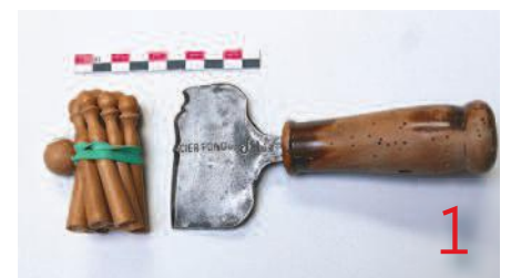
Curette profilée pour réaliser des quilles miniatures en buis, origine village de Meussia (Jura). Acier de récupération.
