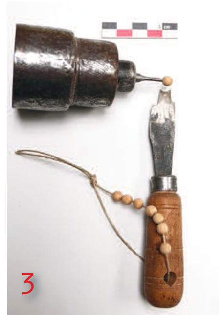
Curette pour perle en buis de 7 mm, montée ici sur sa broche de tournage. Perle percée avec un trou de 1,5 mm. Parfois un échantillon est accroché au manche de la curette.
