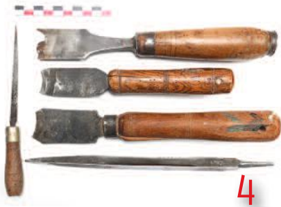
Curettes pour moulures ovoïdes, bouton de tiroir et deux affiloirs pour redresser le fil des outils après affûtage.
