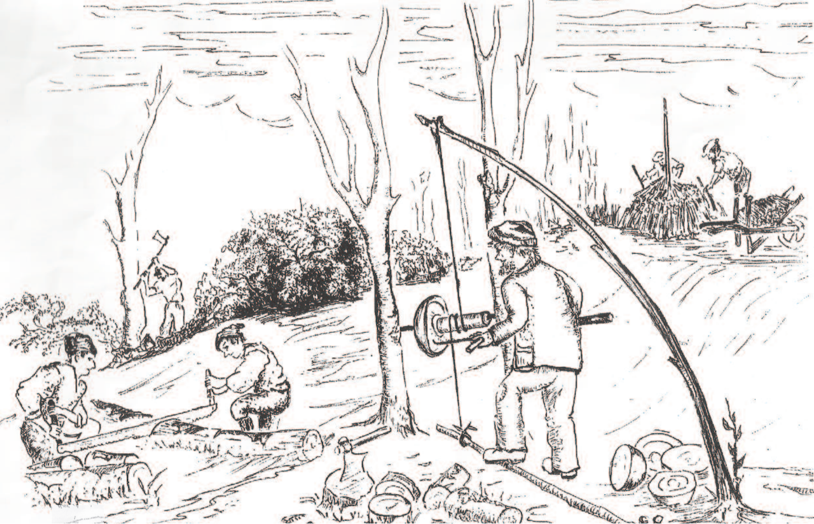
4 Dessin au trait de Roger Bouvier. L'un des tours à vaisselle qui pouvait fonctionner sur les lieux de la coupe.
